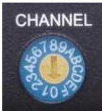
Рис.9 Dip переключатели передатчиков VKM04T и приёмников VKM04R
